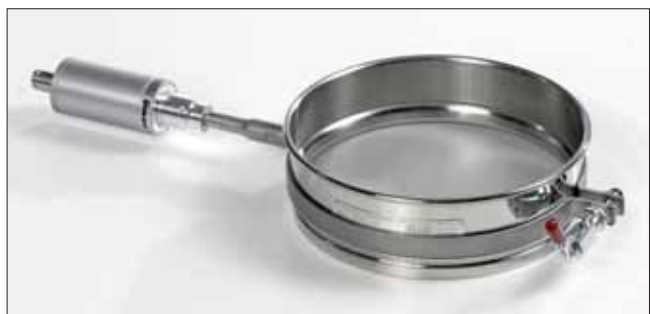
Excitación vertical y lateral de tamices con sistema de variación de frecuencia ARTECH
